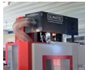
Ölnebelabscheider auf Bearbeitungszentrum installiert
